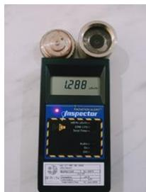
Gambar 7. Hasil pengujian pertama detektor buatan industri
