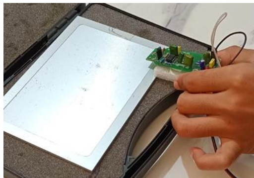
Gambar 13 pengambilan data detektor beta dengan sumber selama 2 menit.
