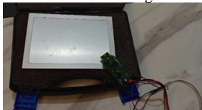
Gambar 9 pengambilan data detektor alpha dengan sumber selama 2 menit
